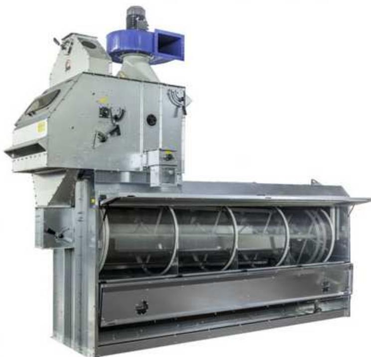
Nos nettoyeurs trieurs rotatifs assurent avec efficacité le nettoyage et le triage des grains après la récolte et avant le stockage en silos. Ils séparent du bon grain, les poussières, les grains cassés, les petites graines, les déchets légers et les grosses impuretés.
