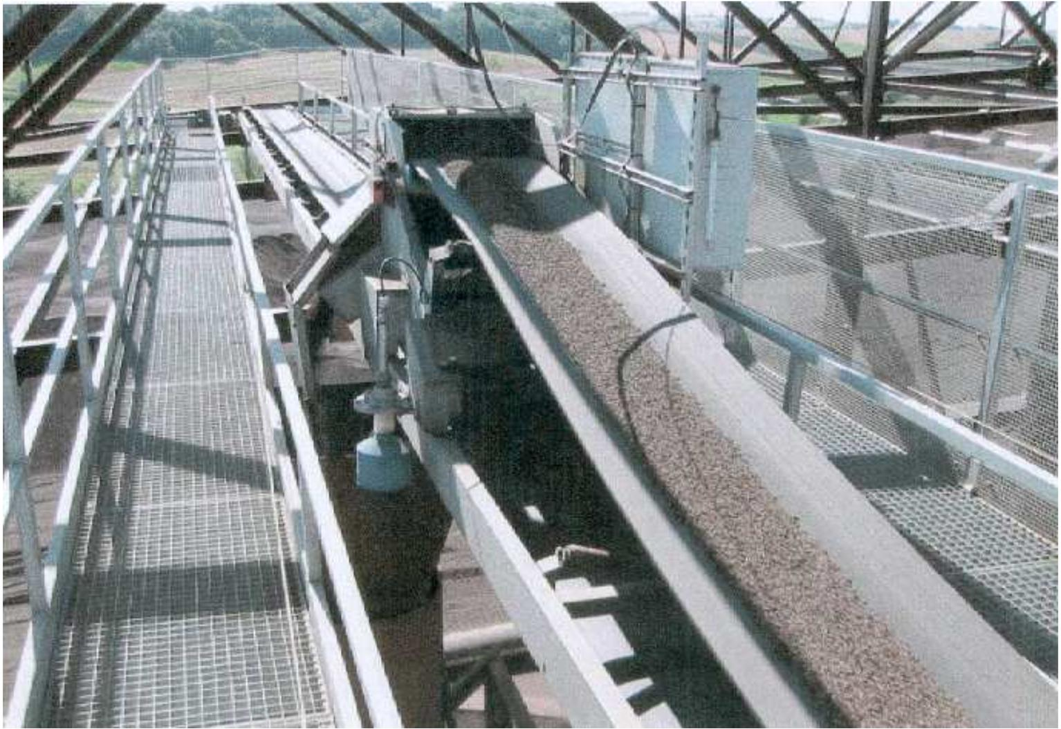
**CONVOYEURS A BANDE AVEC CHARIOT DE VIDANGE TYPE C800**
