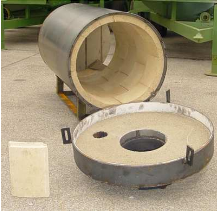
Chambre de combustion garnie de briques réfractaires à l'intérieur
