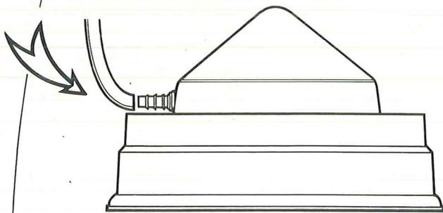
Engager le tuyau d'alimentation d'eau (5 x 9) sur l'embout cannelé et l'enfoncer au maximum.
