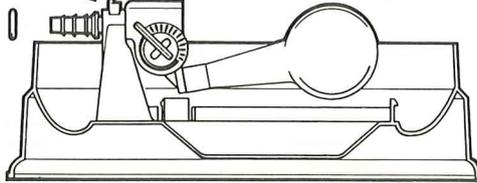
En tenant d'une main la colonne verticale, enfoncer de l'autre main le clapet-flotteur jusqu'en butée contre la colonne.
