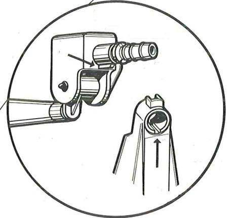
Aligner la clavette de l'embout cannelé dans la rainure de la colonne verticale.
