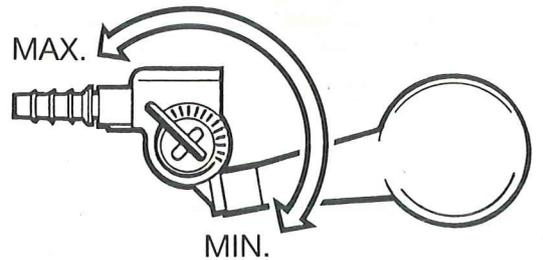
Le niveau d'eau dans l'abreuvoir est réglable. Pour ce faire, démonter le couvercle (sans débrancher le tuyau) et tourner la manette de réglage vers la gauche pour augmenter le niveau d'eau ou vers la droite pour le diminuer.
