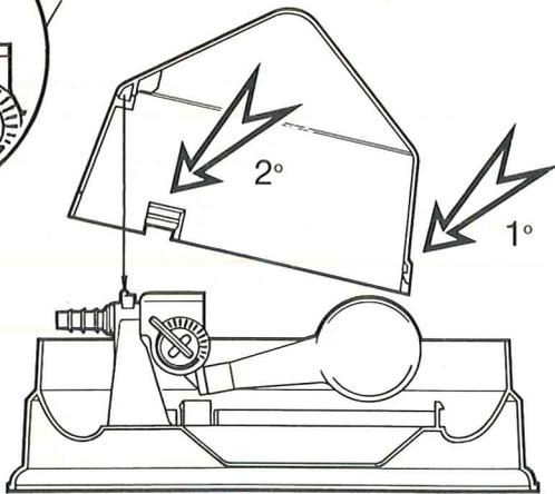
Prendre le couvercle conique, faire passer l'embout cannelé dans le trou du couvercle, incliner le couvercle vers le bas côté flotteur; engager le couvercle sur le clips de la base, côté flotteur, ensuite, d'un mouvement de bascule opposé, appuyer sur le couvercle, côté arrivée d'eau, pour clipser les 2 autres points d'ancrage du couvercle sur la base, jusqu'à un parfait emboîtement.
