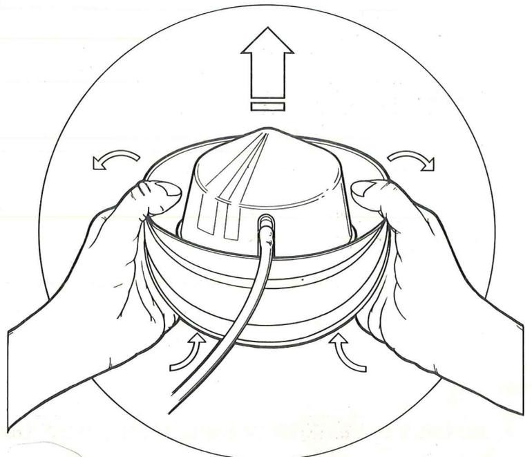
Pour démonter facilement le couvercle conique, prendre la base de l'abreuvoir à deux mains, pouces appuyés sur le rebord supérieur, appuyer avec les autres doigts sous la base, en son centre, en écartant les pouces jusqu'à ce que le couvercle sorte des clips. On peut également le démonter en appuyant avec les deux pouces sur le rebord supérieur vers l'intérieur et en écartant avec les autres doigts le dessous extérieur de la base.
