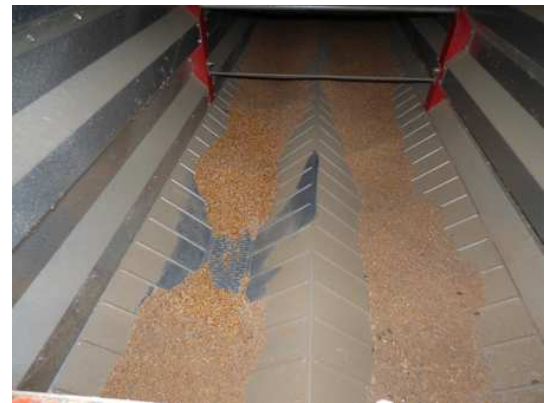
Silo en phase finale de vidange par la ventilation
