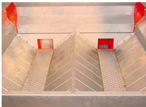
La base des silos est équipée de caniveaux de ventilation
